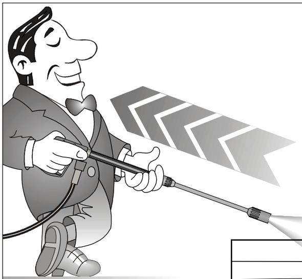
Achten Sie darauf, daß beim Reinigen mit unter Hochdruck stehendem Wasser an der Lanze ein deutlich spürbarer Rückstoß entsteht. (siehe techn. Daten S. 2)
