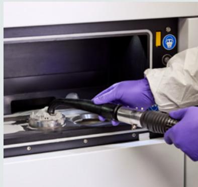
Die Modelle mit sicherer Entsorgung schützen den Bediener während des Entsorgungsprozesses beim Umgang mit gefährlichem Staub perfekt.
